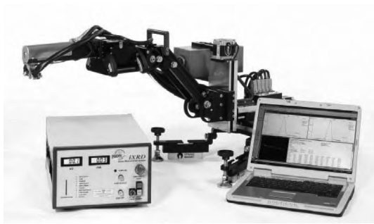
图2 iXRD残余应力仪
