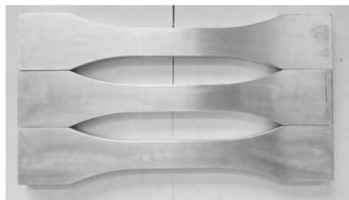
图 3 标准平滑接头疲劳试样
